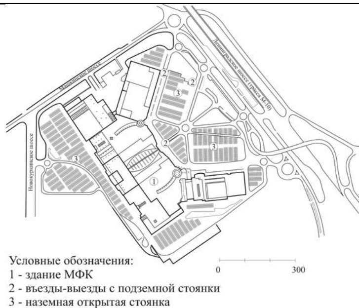
Рис. 2. Схема генплана многофункционального комплекса, расположенного за городом (г.Химки, Московская область, Ленинградское шоссе, трасса М-10, 2004 г., Callison Architecture Inc.)
