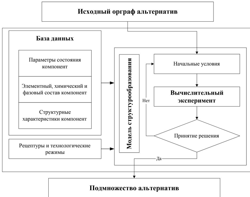
Рис. 1. Исходные данные и алгоритм моделирования
